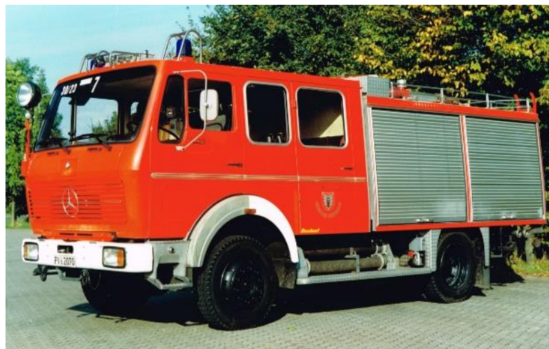
Fahrzeugtyp: TLF 16 Fahrgestell: Daimler Benz DB1019AF Aufbau: Gebr. Bachert, Bad Friedrichshall Preis: 189.500,- DM
