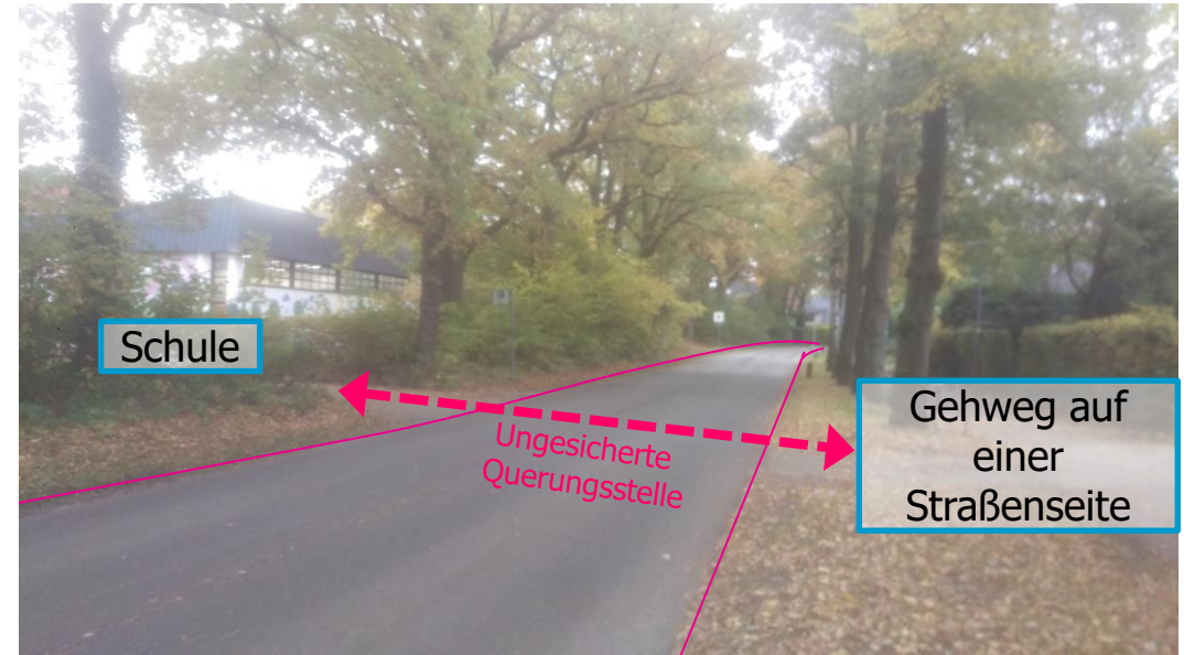
Fehlende Querungshilfe zum Eingang der Schule, Breiter Weg, eigene Aufnahme
